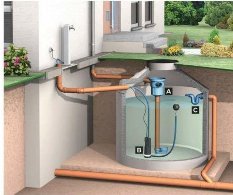
**Beinhaltet:** A Gartenfilter und beruhigter Zulauf, B Tauchpumpe mit schwimmender Ansaugarmatur und C Überlaufsiphon.
