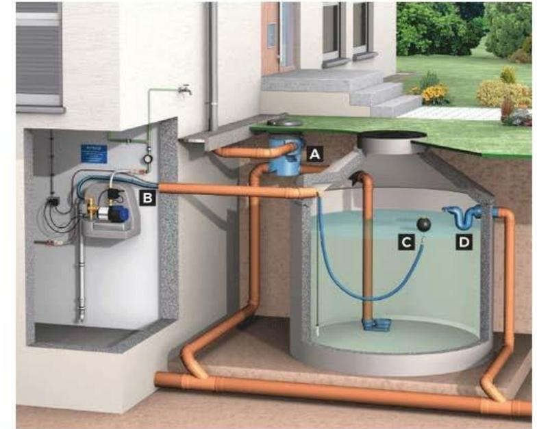
**Beinhaltet:** A Volumenfilter und beruhigter Zulauf, B Hausanschlussbox mit Pumpe, C schwimmende Ansaugarmatur und D Überlaufsiphon.
