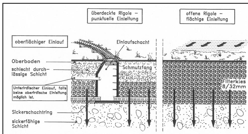
Rigolen sind mit Grobkies oder Schotter gefüllte Versickerungsgräben. Im Gegensatz zu den vorgenannten Mulden-Rigolen wird das zu versickernde Wasser aber direkt in den Graben eingeleitet. Bei dieser Lösung fehlt die reinigende Wirkung der bewachsenen Mutterbodenschicht und das Speichervolumen in der Mulde. Die Zwischenspeicherung vor der Versickerung findet nur in dem unterirdischen Teil der Rigole statt.
