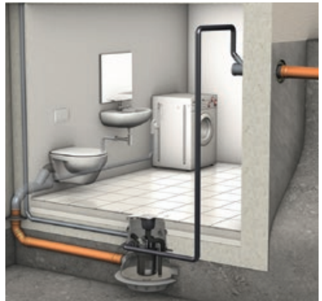
43 Funktionsprinzip einer Hebeanlage
