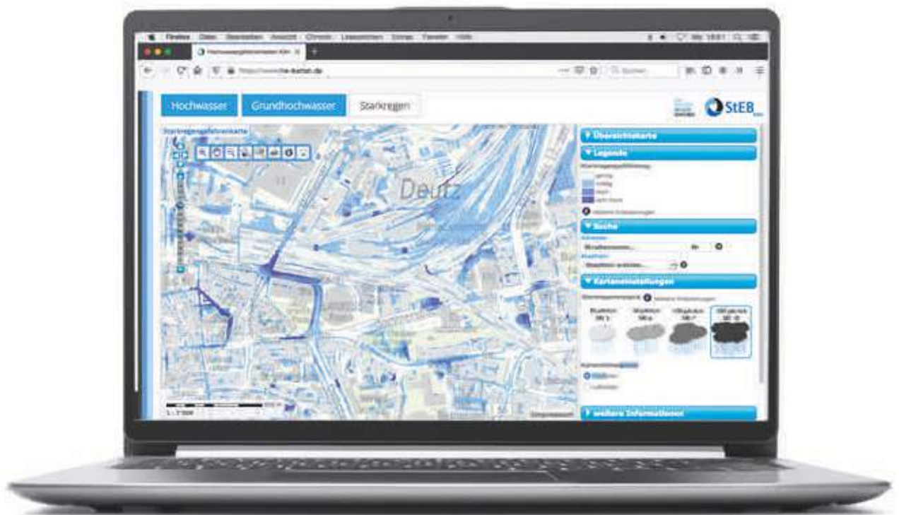
Beispiel einer digitalen Starkregengefahrenkarte mit Möglichkeit zum Umlenden auf die Hochwassergefahrenkarte und eine Grundhochwassergefahrenkarte (Beispiel StEB-Köln, https://www.hw-karten.de/ )
