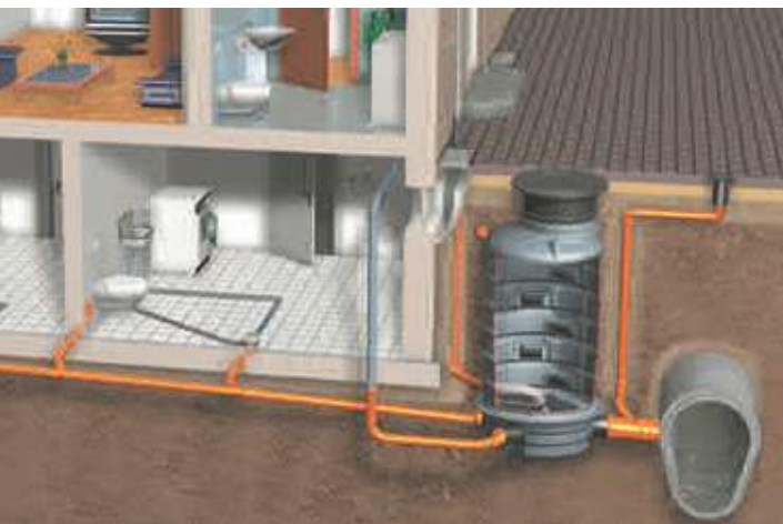
Rückstausicherung außerhalb des Gebäudes
