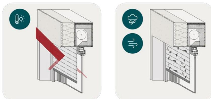
**Abb. 62** Auswirkungen der Wetterelemente auf die Sonnenschutzsysteme. Links: Hitzeeintrag in das Bauteil. Rechts: Schäden an den Lamellen infolge von Hagel und Sturm.
