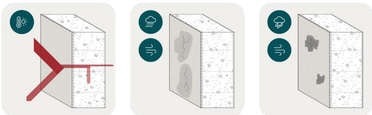
**Abb. 51** Auswirkungen der Wetterelemente auf die Porenbetonkonstruktion. Links: Hitzeeintrag in das Bauteil. Mitte: Feuchteintrag infolge Schlagregen. Rechts: Schäden am Putzsystem infolge Hagel und Sturm.
