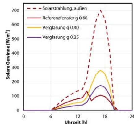
**Abb. 60** Solarstrahlung außen und solare Gewinne in Abhängigkeit der Zeit. Die Solarstrahlung außen stellt die auf die vertikale Außenoberfläche auftreffende Sonneneinstrahlung dar. Die anderen Verläufe zeigen den solaren Energieeintrag in den Innenraum durch ein westorientiertes Fenster.
