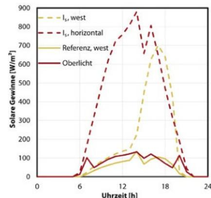
**Abb. 78** Solarstrahlung ( $I_s$ ) außen und solare Gewinne in Abhängigkeit der Zeit. Die Solarstrahlung außen west und die Solarstrahlung horizontal stellen die auf die vertikale bzw. horizontale Außenoberfläche auftreffende Sonneinstrahlung dar. Die anderen Verläufe zeigen den solaren Energieeintrag in den Innenraum durch ein west- bzw. horizontal orientiertes Fenster.
