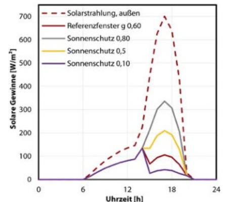
**Abb. 63** Solarstrahlung außen und solare Gewinne in Abhängigkeit der Zeit. Die Solarstrahlung außen stellt die auf die vertikale Außenoberfläche auftreffende Sonneneinstrahlung dar. Die anderen Verläufe zeigen den solaren Energieeintrag in den Innenraum durch ein westorientiertes Fenster.
