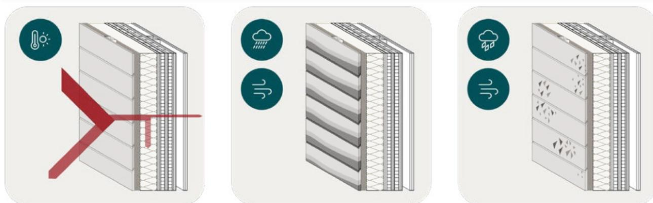
Abb. 48 Auswirkungen der Wetterelemente auf die hinterlüftete Holzmassivbaukonstruktion. Links: Hitzeeintrag in das Bauteil. Mitte: Feuchteintrag infolge Schlagregen. Rechts: Schäden an der Holzoberfläche infolge Hagel und Sturm.
