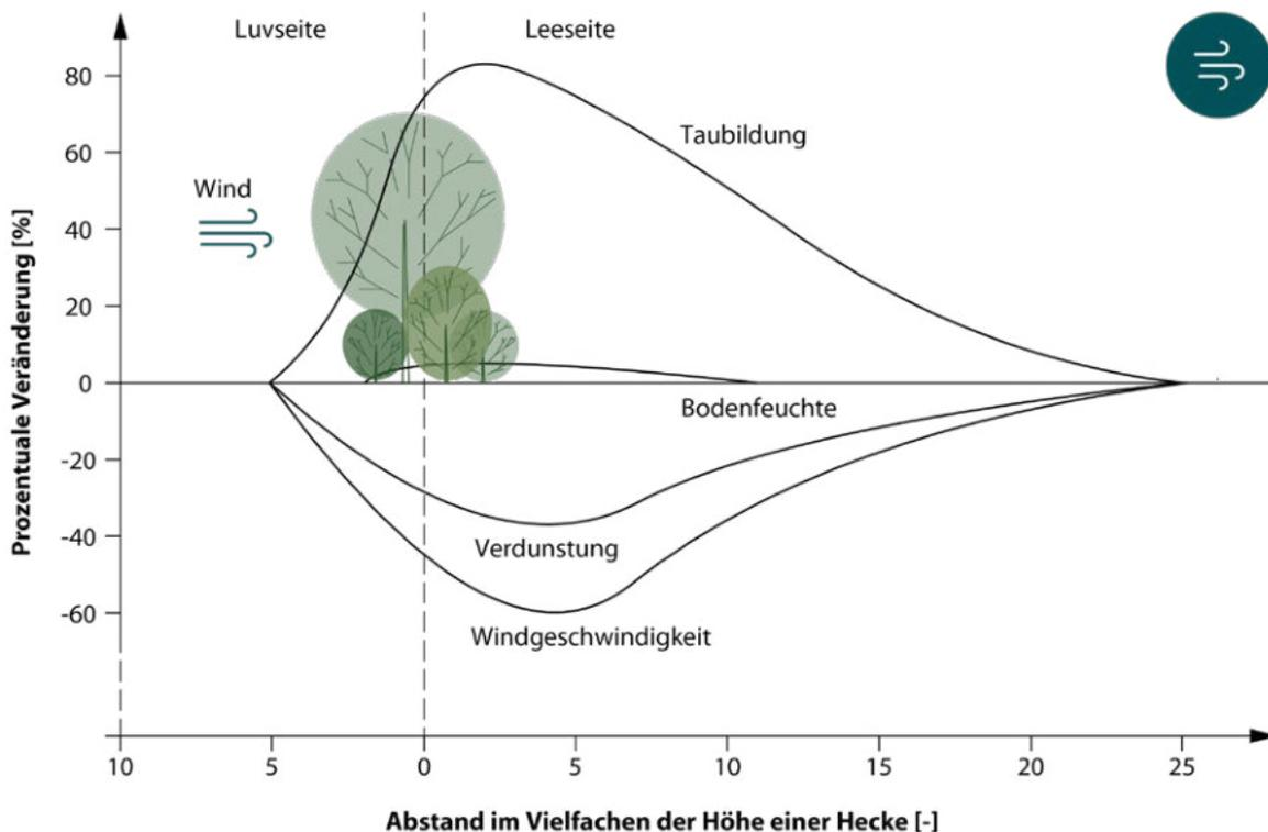
**Abb. 35** Qualitative Darstellung der Wirkungen von Gehölzen auf mikroklimatische Faktoren der direkten Umgebung bei Windeinwirkung nach (StartClim2008 2009). Größe der Bepflanzung überhöht dargestellt.
