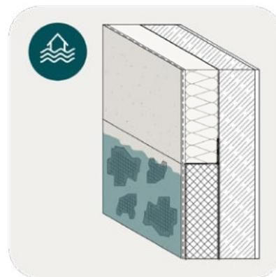
**Abb. 80** Auswirkungen der Überflutung auf das Wärmedämmverbundsystem. Bauteilschäden infolge hoher hygriker Belastung.
