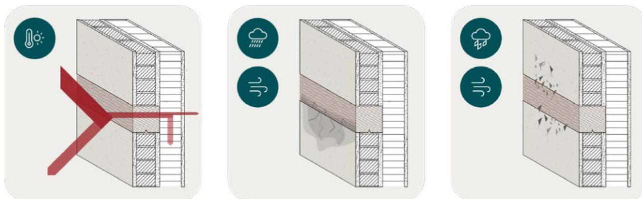
Abb. 45 Auswirkungen der Wetterelemente auf die Fachwerkkonstruktion. Links: Hitzeeintrag in das Bauteil. Mitte: Feuchteintrag infolge Schlagregen. Rechts: Schäden am Putzsystem infolge Hagel und Sturm.
