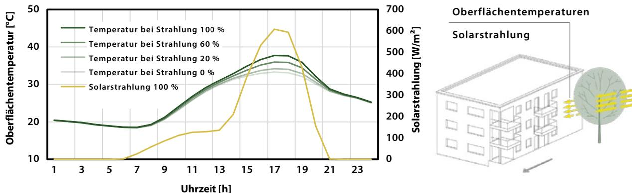
**Abb. 32** Änderung der Oberflächentemperatur im Außenraum in Abhängigkeit des Strahlungseintrags auf die Westfassade über 24 h. Die Oberflächentemperatur wird jeweils mit 100 %, 60 %, 20 % und 0% Strahlungseinfall simuliert.
