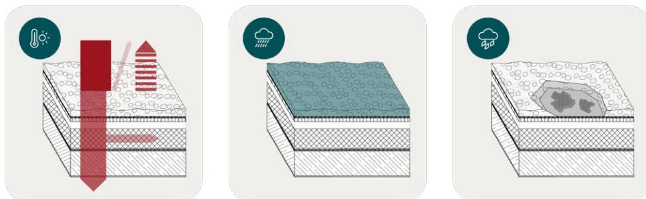
**Abb. 68** Auswirkungen der Wetterelemente auf das Kaltdach. Links: Hitzeeintrag in das Bauteil. Mitte: Überflutung der Dachfläche infolge Starkregen. Rechts: Beschädigungen infolge Hagel.
