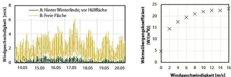
**Abb. 36** Links: Vergleich der Windgeschwindigkeit zwischen Winterlinde und Fassadenoberfläche (Graph A) sowie einer freien Fläche (Graph B) bei einer Messreihe im Mai 2020 in Stuttgart-Vaihingen. Rechts: Einfluss der Windgeschwindigkeit auf den konvektiven Wärmeübergangskoeffizienten nach (Mayer, E. et al. 2018).
