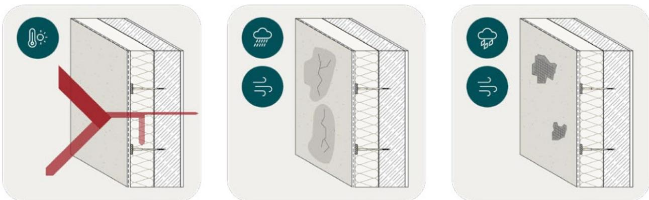
**Abb. 39** Auswirkungen der Wetterelemente auf das Wärmedämmverbundsystem. Links: Hitzeeintrag in das Bauteil. Mitte: Feuchteintrag infolge Schlagregen. Rechts: Schäden am Putzsystem infolge Hagel und Sturm.
