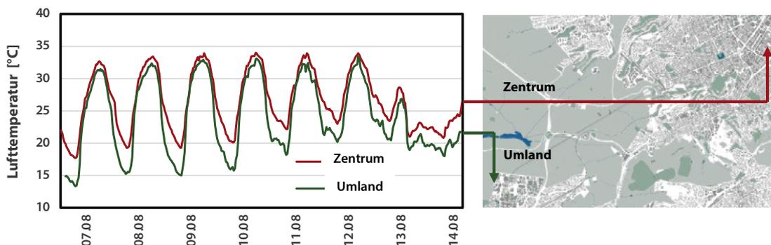
**Abb. 22** Vergleich der gemessenen Lufttemperatur im Stuttgarter Zentrum (Abt. Stadtklimatologie 2020) sowie im Stuttgarter Umland (IWS 2020) während einer Woche im August 2020. Links: Darstellung der Messdaten der Lufttemperatur. Rechts: Karte mit markierten Standorten.
