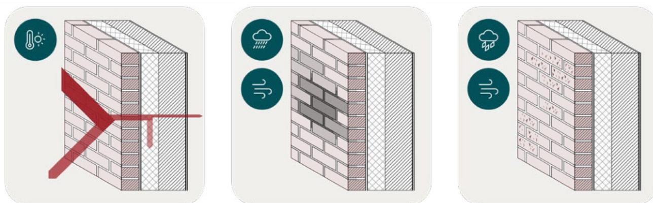
**Abb. 42** Auswirkungen der Wetterelemente auf die Mauerwerkskonstruktion. Links: Hitzeeintrag in das Bauteil. Mitte: Feuchteintrag infolge Schlagregen. Rechts: Schäden am Mauerwerk infolge Hagel und Sturm.
