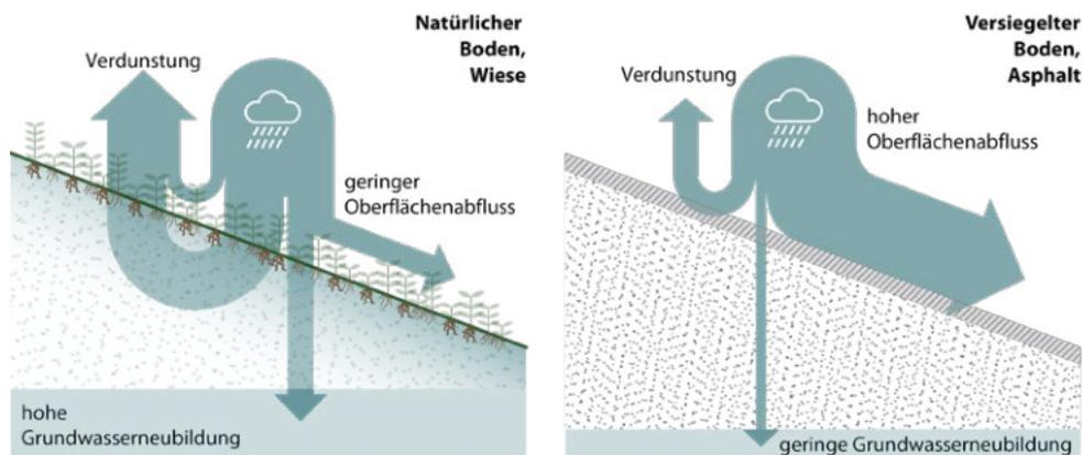
**Abb. 24** Qualitative Darstellung des Regenwasserabflusses. Links: Regenwasserabfluss auf einem steilen Gelände mit unversiegelter Wiesenfläche. Rechts: Regenwasserabfluss auf einem steilen Gelände mit versiegelter Asphaltfläche.
