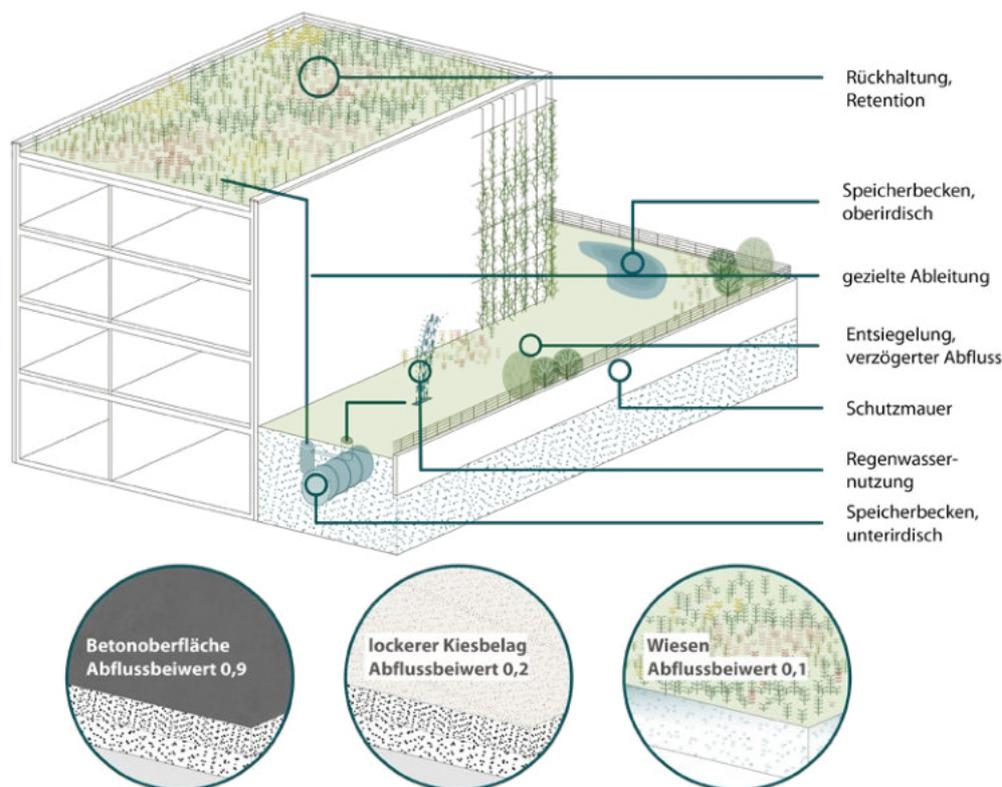
**Abb. 25** Ausgewählte vorbeugende Maßnahmen für Liegenschaften zur Anpassung an Starkregen und Hochwasser. Untenstehend sind weiter beispielhaft drei Abflussbeiwerte von gängigen Oberflächen auf privaten Grundstücken dargestellt.
