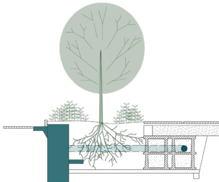
**Abb. 34** Rigolensystem zur Bewässerung von Straßenbäumen in Toronto nach (Deeproot - 2017).
