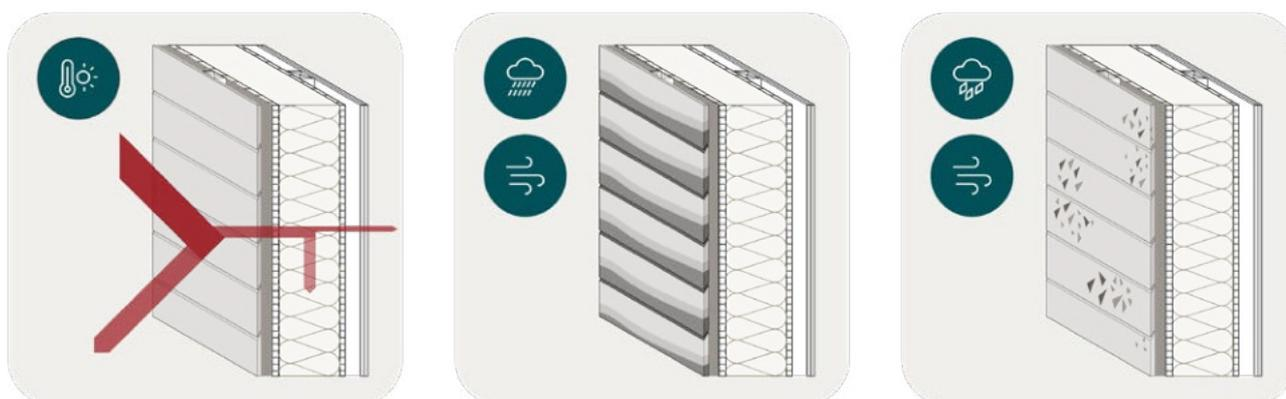
**Abb. 54** Auswirkungen der Wetterelemente auf die hinterlüftete Holzleichtbaukonstruktion. Links: Hitzeintrag in das Bauteil. Mitte: Feuchteintrag infolge Schlagregen. Rechts: Schäden an der Holzoberfläche infolge Hagel und Sturm.
