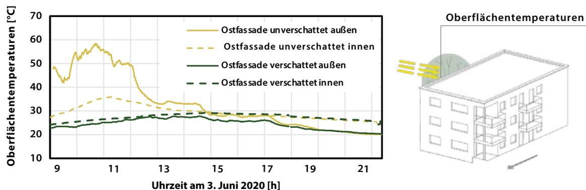
**Abb. 31** Außenseitige und innenseitige Oberflächentemperaturen einer unverschatteten sowie einer verschatteten Ostfassade (durch Winterlinde) im Vergleich. Die messtechnische Untersuchung wurde im Juni in Stuttgart durchgeführt.
