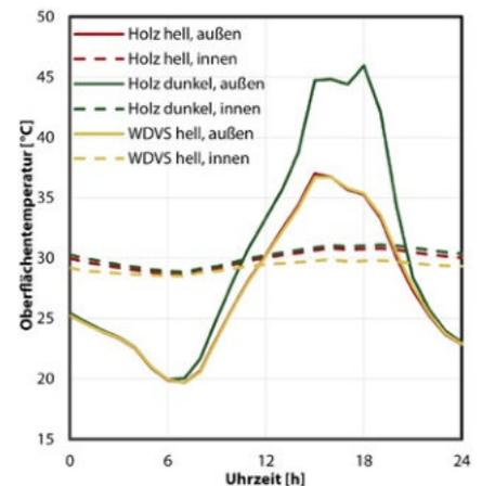
**Abb. 55** Oberflächentemperaturverläufe außenseitig sowie innenseitig über einen Tag in Abhängigkeit der Holzvorsatzschalenfarbe.
